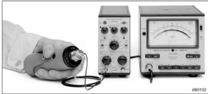
Фиг.2.3 Калибриране на система за измерване на вибрации
