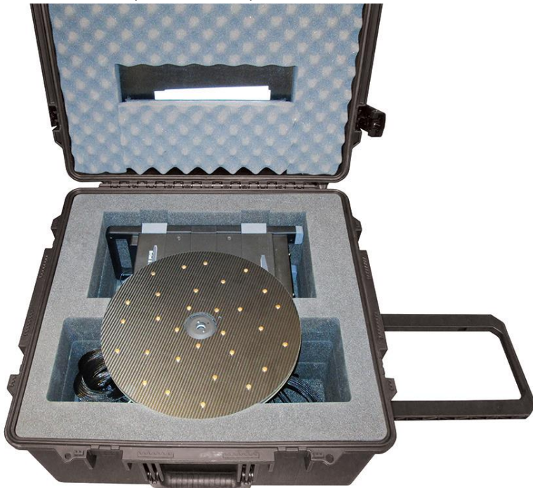
Фиг. 1 Акустична камера тип 9712-W-FEN в калъфа за носене
